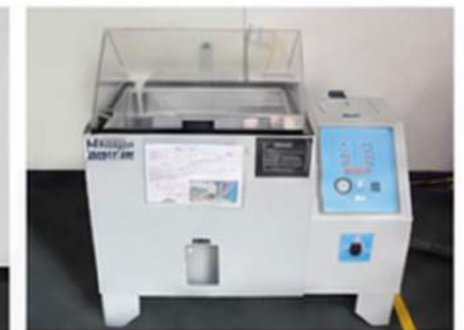
▲ 盐雾试验机 Salt Spray Test Chamber
