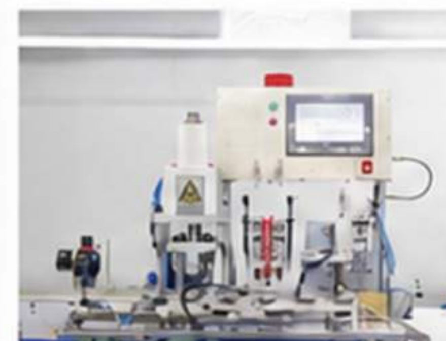
▲ 自动绑合机 Automatic Rotor Assembly Machine
