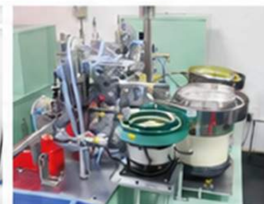
▲ 自动转子机 Automatic Balancing Machine
