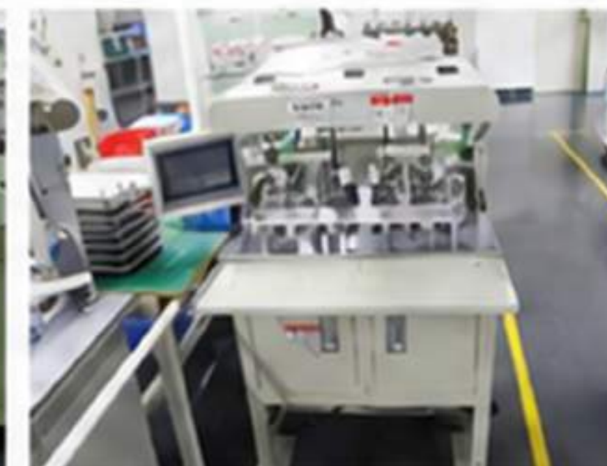
▲ 自动压敏焊接机 Automatic Varistor Welding Machine
