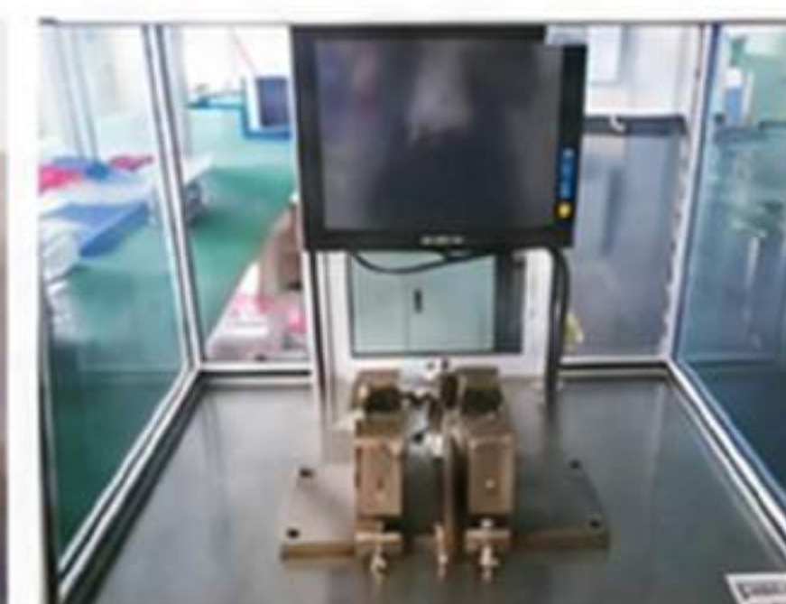
▲ 自动平衡机 Automatic Balancing Machine
